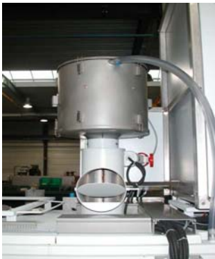
condenseur de vapeurs
